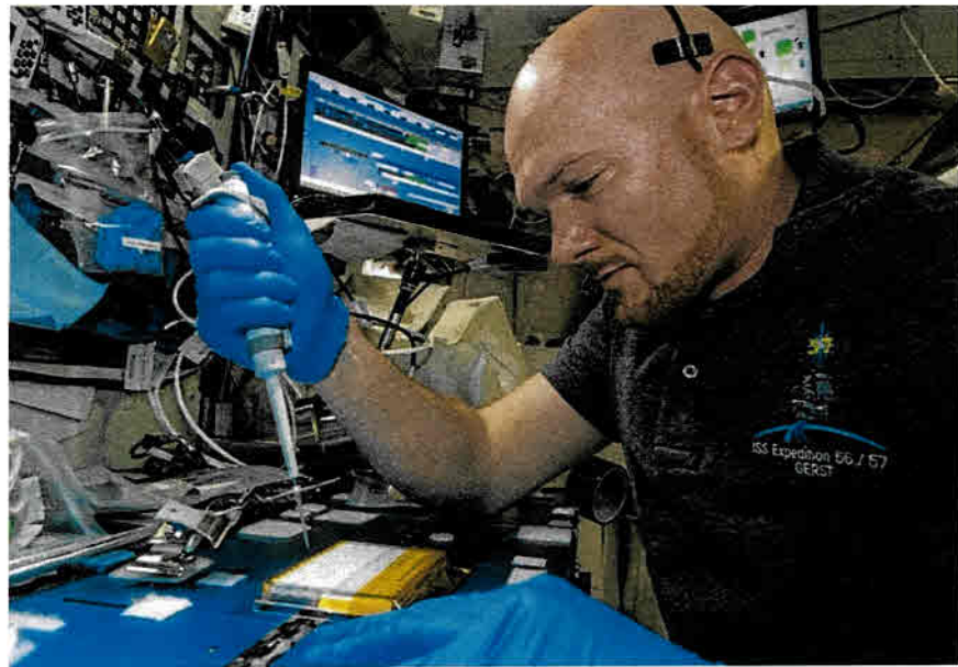
ESA-Astronaut Alexander Gerst überträgt eine Proteinlösung in eine Proteinkristall-Wachstumskarte (oben links, darunter eine Kartenprobe unter dem Mikroskop). Im All wachsen Proteinkristalle makelloser als auf der Erde. Die Experimente helfen zu verstehen, welche Rolle diese Eiweißstrukturen bei verschiedenen Krankheiten spielen. Oben rechts: In der Schwerelosigkeit verbesserte Gewebenchips bieten die Chance, neue Medikamente zu testen.
